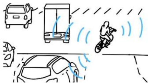
测距测速 两轮车雷达
